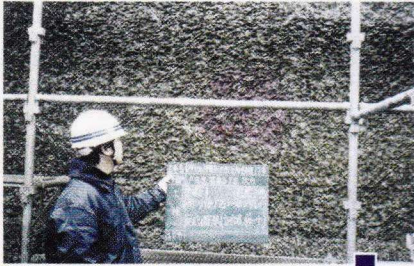
研り後 フェノールフタレイン溶液 にて反応検査
